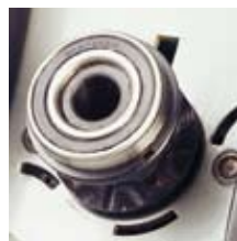
Wysokowartościowe okapturzone łożysko oraz panewka ślizgowa.
